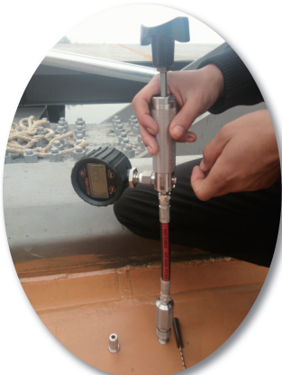
防水材料抗拉拔实验
